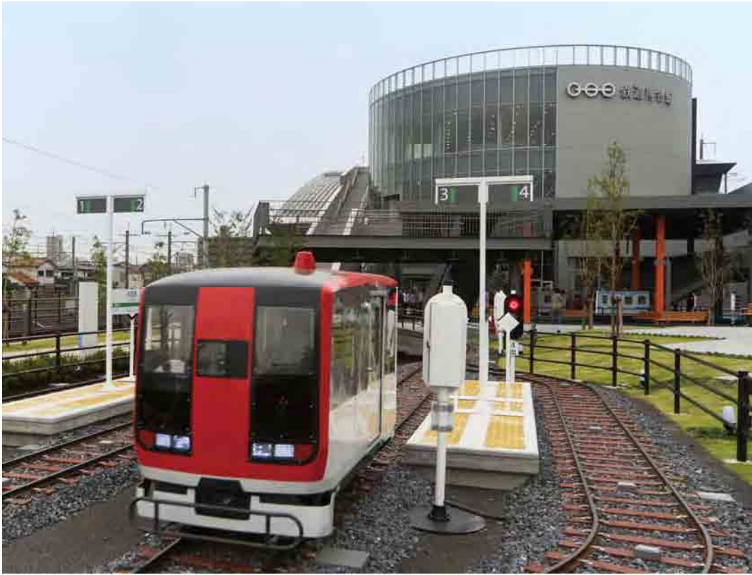
الصورة ٢١ قطار مصغر بنظام قيادة ذاتية مع نظام تحكم تلقائي
